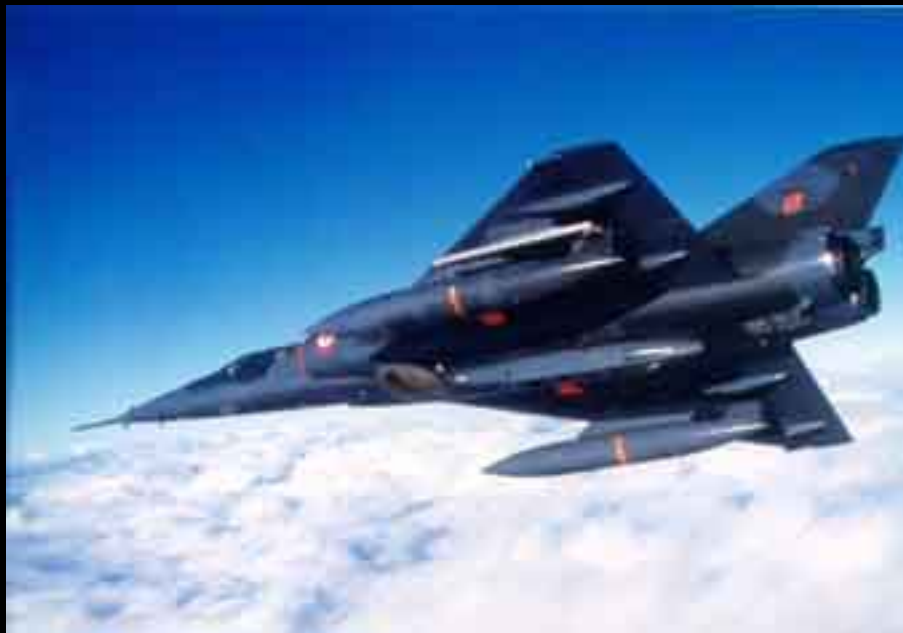
Le Mirage IVP en version reconnaissance. On aperçoit sous l'aile gauche la nacelle de brouillage BARRACUDA
