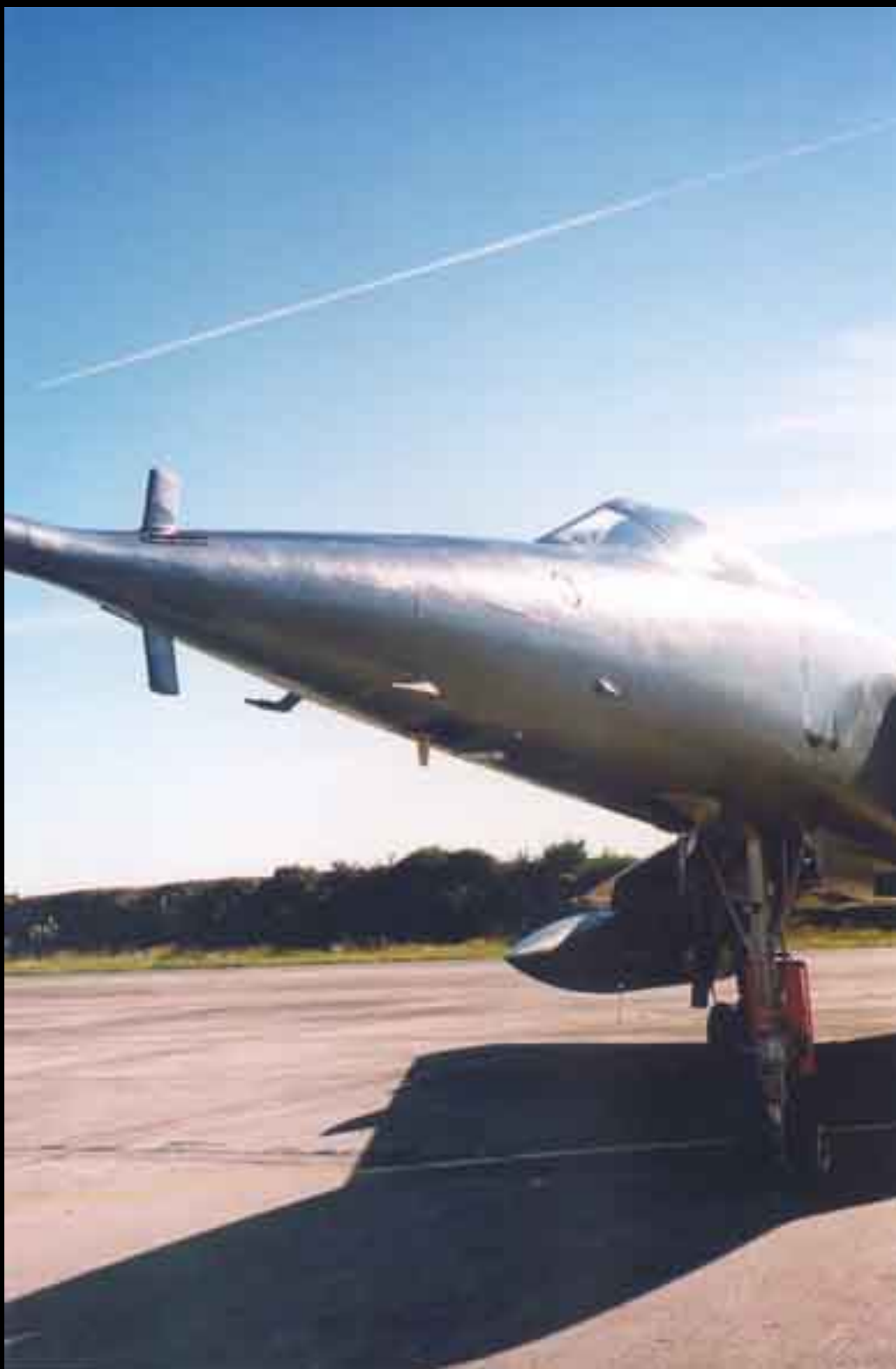
Le brouilleur Agasol, reconnaissable à ses deux antennes verticales. La photo a été prise sur la base aérienne de Cazaux en septembre 2002.
